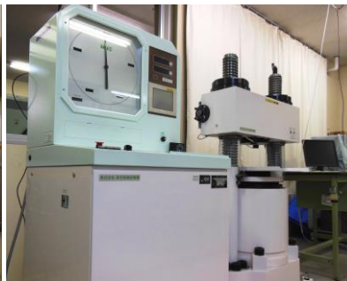
(左) 300kN 万能試験機 (中) 2,000kN 圧縮試験機 (下) 試験審査所改築イメージ
